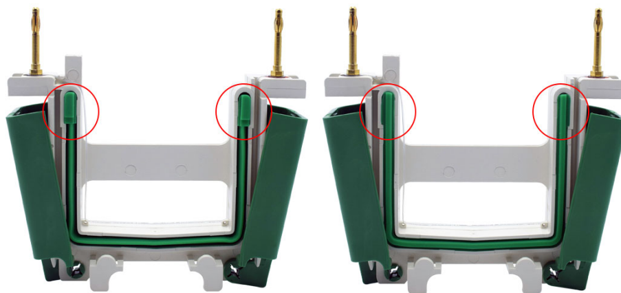
图1. 碧云天、Bio-Rad等公司的电泳槽U型硅橡胶密封条的突起结构图。由于碧云天的BeyoGel™ Plus PAGE预制胶的该部位是平的，使其兼容几乎所有厂家的小型胶电泳槽，所以电泳时须将具有突起结构的硅橡胶密封条(左图)取出后反过来安装(右图)，使其没有突起的平滑面朝外，从而防止漏液。
